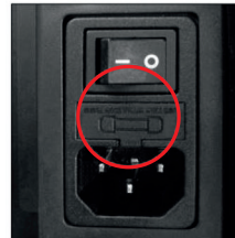
Photo 3 : La cosse du fusible.
